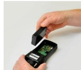
Die Gehäuse Klappe kann aufgelegt und mit den vier TORX-Schrauben handfest befestigt werden.
