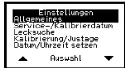
Haben Sie einen der Menüpunkte in den Einstellungen ausgewählt, können Sie mit ENTER alle angezeigten Einträge einmal vollständig durchlaufen. Mit F1 / F2 ändern Sie einen Wert.
