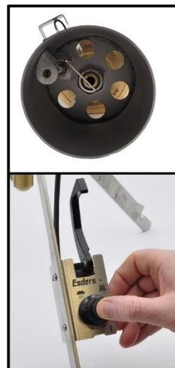
**Hinweis, Zünder arretieren:** Sie können den Zünder dauerhaft auslösen lassen. (1) Arretieren Sie den Feststellbügel. (2) Lösen Sie den Feststellbügel, um die dauerhafte Zündung zu unterbrechen.
